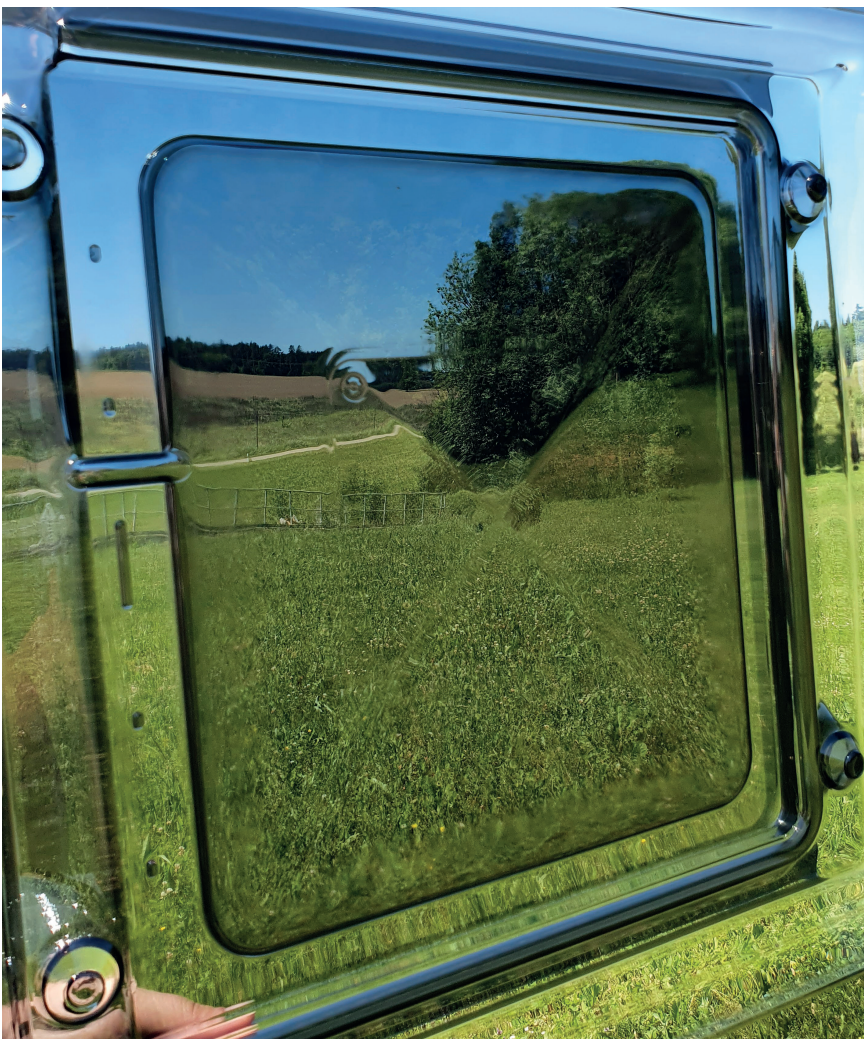
Transparenter Hohlkörper: Hergestellt mit einem Twin-Sheet-Versuchswerkzeug zur Erzeugung verschiedener Oberflächenbeschaffenheiten © Linbrunner Thermoformung
